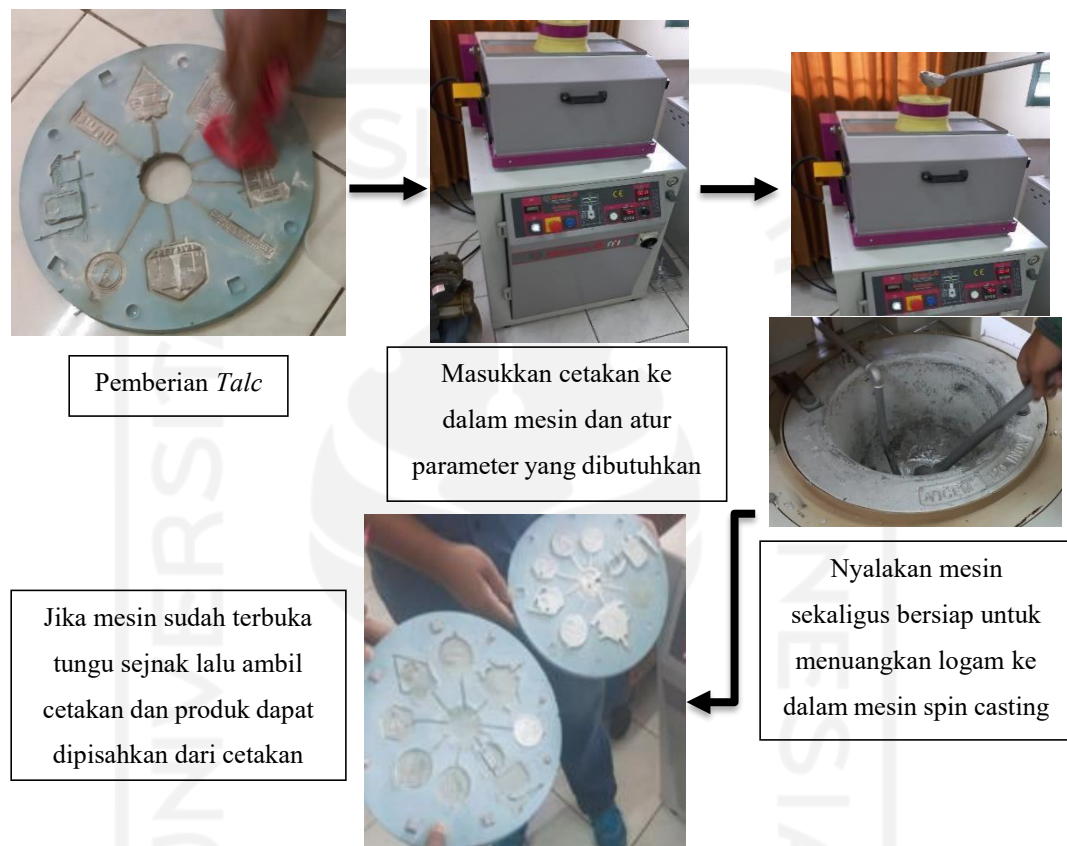
Gambar 4-5 Tahapan proses pengecoran dengan mesin spin casting
