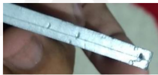
Gambar 4-7 Cacat produk pada kecepatan 650 RPM
