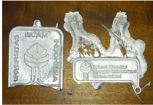
Gambar 4-8 Contoh kegagalan produk pada kecepatan 850 RPM
