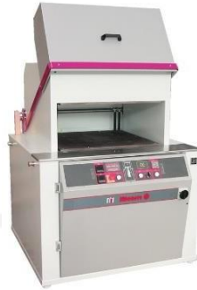
Gambar 3-4. Mesin Vulkanisasi (NICEM P 700 MASTER)
