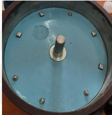
Gambar 3-12 Pengikisan cetakan dan pemasangan pin penghubung
