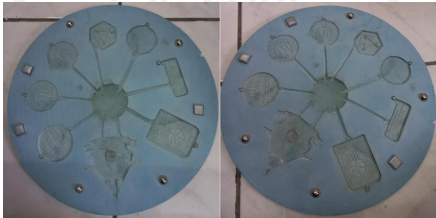
Gambar 4-3 Hasil Pembuatan Pola pada Cetakan Karet
