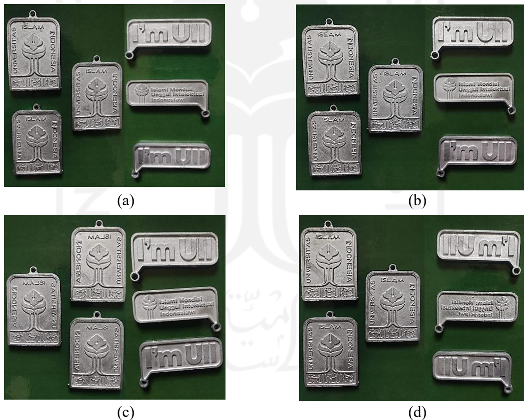
Gambar 4-6 Hasil Pengujian Variasi Kecepatan Putaran
