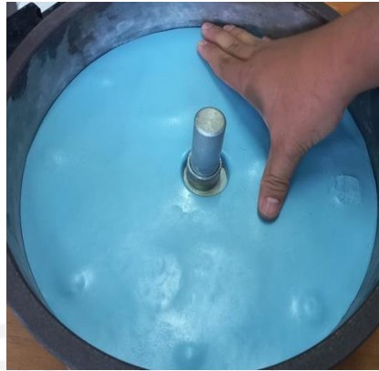
Gambar 3-14 Pemasangan cetakan karet bagian atas
