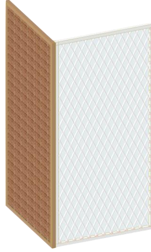
Gambar 13. Material anyaman rotan sintetis dan wire mesh pada fasad Fore Coffee
