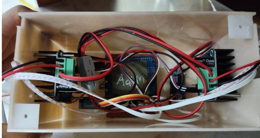
Gambar 4-7 Rangkaian Sistem Kendali
