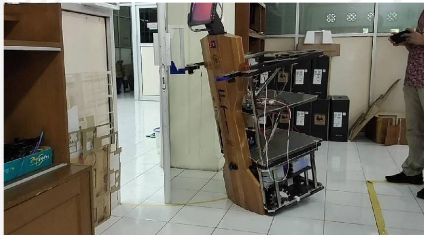
Gambar 4-21 Masalah roda robot terangkat ketika proses membuka pintu
