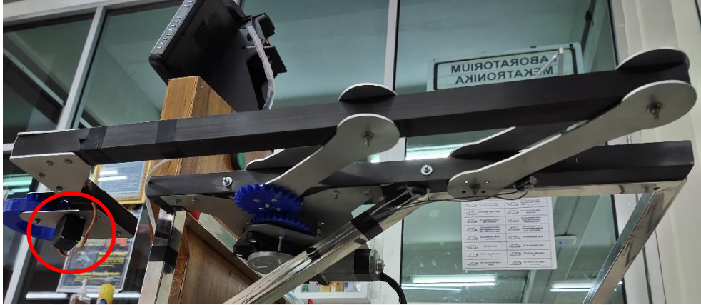
Gambar 4-5 Posisi peletakan motor servo
