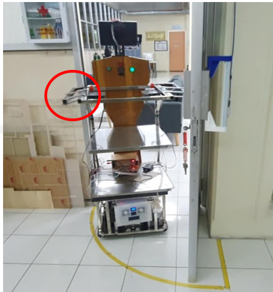
Gambar 4-24 Mekanisme pembuka pintu robot tersangkut pada kusen pintu
