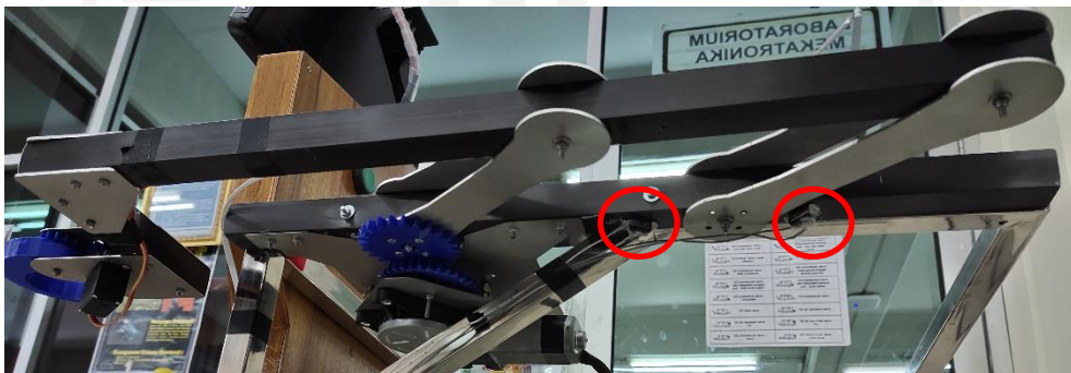
Gambar 4-6 Posisi peletakan limit switch
