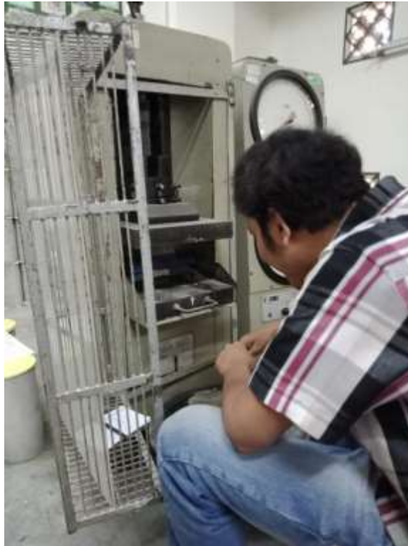
Gambar L-2.1 Pengujian Kuat Tekan Paving Block
