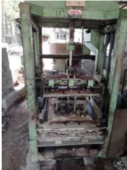
Gambar 4.8 Mesin Press Paving Block (Sumber : Dokumentasi Pribadi)
