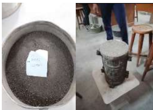
Gambar 5.4 Pengujian Berat Volume Gembur dan Padat Pasir (Sumber : Dokumentasi Pribadi)
