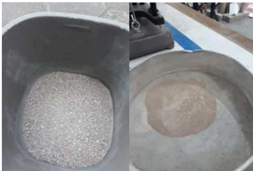
Gambar 5.1 Hasil Sebelum dan Sesudah Uji Saringan Butiran Keramik (Sumber : Dokumentasi Pribadi)
