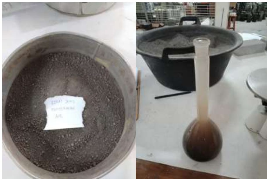
Gambar 5.2 Pengujian Berat Jenis dan Penyerapan Air (Sumber : Dokumentasi Pribadi)
