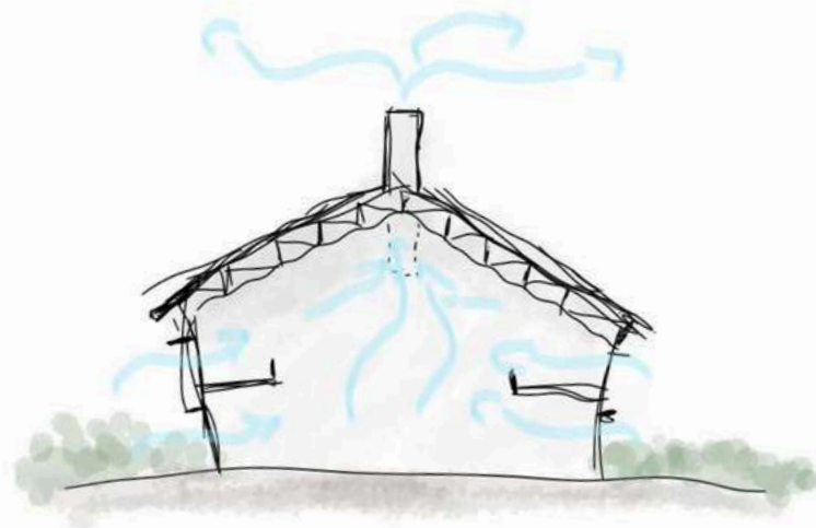
Gambar 56. Konsep ventilasi pada bangunan sumber : penulis, 2024
