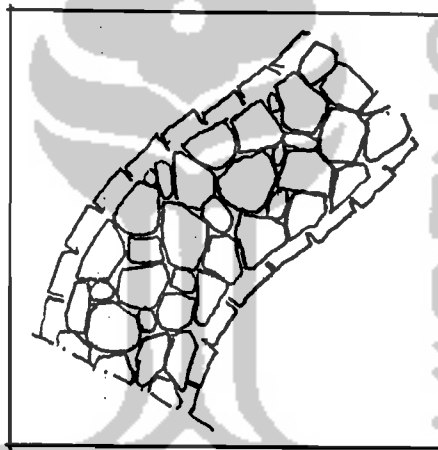
Gambar 4.10.1.3.b : Bahan batu kali (pecah) yang digunakan sebagai penutup jalan setapak
