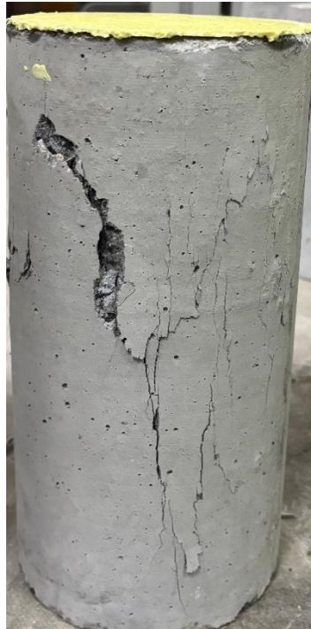
Gambar L-9. 39 Benda Uji setelah Pengujian Kuat Tekan Beton dan Modulus Elastisitas Beton variasi BV-10 Sampel 3
