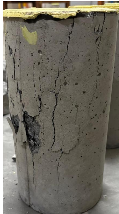
Gambar L-9. 32 Benda Uji setelah Pengujian Kuat Tekan Beton dan Modulus Elastisitas Beton variasi BV-05 Sampel 1
