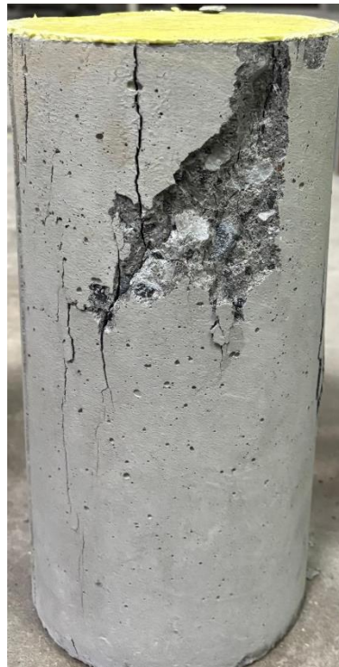
Gambar L-9. 38 Benda Uji setelah Pengujian Kuat Tekan Beton dan Modulus Elastisitas Beton variasi BV-10 Sampel 2
