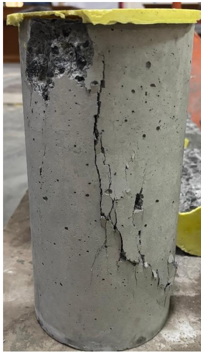
Gambar L-9. 27 Benda Uji setelah Pengujian Kuat Tekan Beton dan Modulus Elastisitas Beton variasi BN Sampel 1
