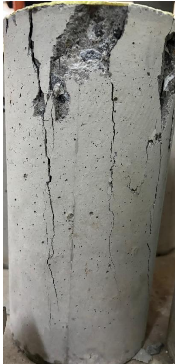
Gambar L-9. 45 Benda Uji setelah Pengujian Kuat Tekan Beton dan Modulus Elastisitas Beton variasi BV-15 Sampel 4
