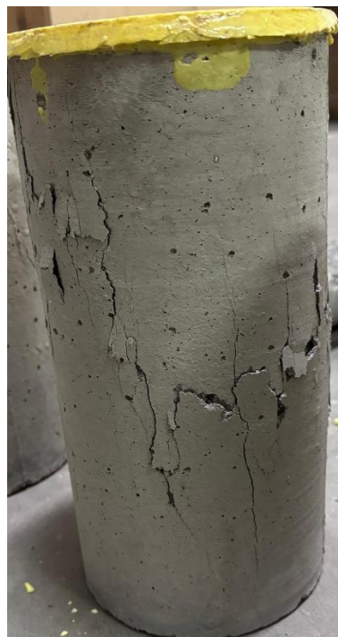
Gambar L-9. 48 Benda Uji setelah Pengujian Kuat Tekan Beton dan Modulus Elastisitas Beton variasi BV-20 Sampel 2
