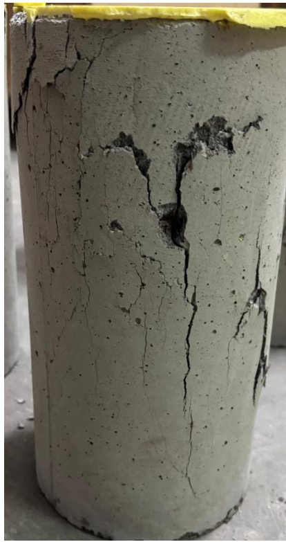
Gambar L-9. 35 Benda Uji setelah Pengujian Kuat Tekan Beton dan Modulus Elastisitas Beton variasi BV-05 Sampel 4
