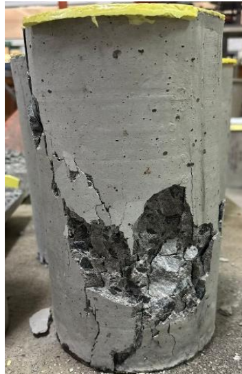
Gambar 5. 9 Contoh Hasil Kuat Tekan Beton (Sumber: Dokumentasi Pribadi)
