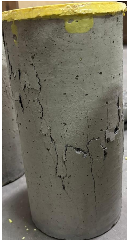
Gambar L-9. 33 Benda Uji setelah Pengujian Kuat Tekan Beton dan Modulus Elastisitas Beton variasi BV-05 Sampel 2
