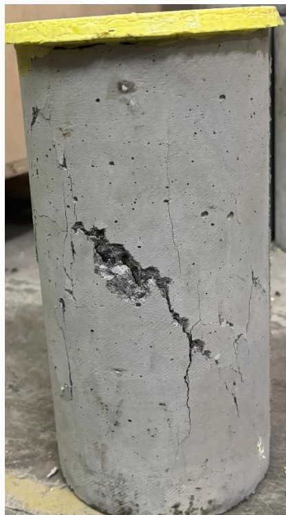
Gambar L-9. 50 Benda Uji setelah Pengujian Kuat Tekan Beton dan Modulus Elastisitas Beton variasi BV-20 Sampel 4
