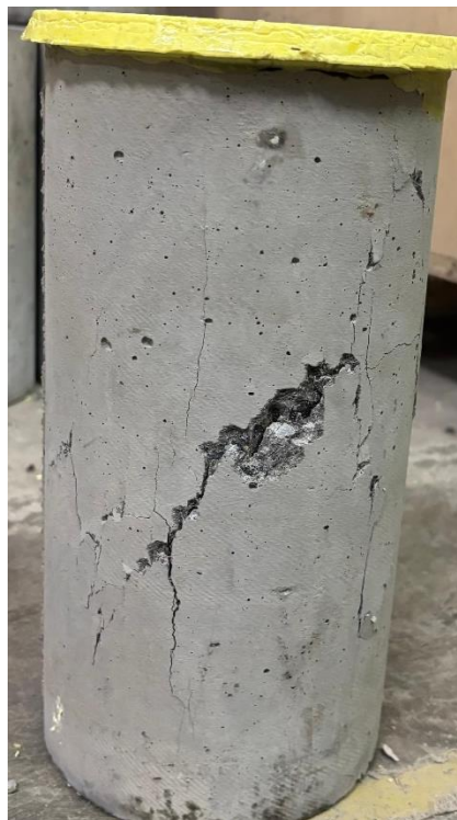
Gambar L-9. 40 Benda Uji setelah Pengujian Kuat Tekan Beton dan Modulus Elastisitas Beton variasi BV-10 Sampel 4
