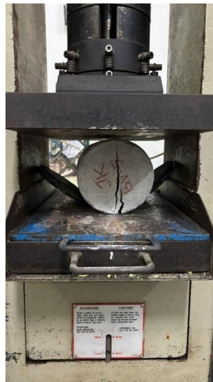
Gambar 5. 26 Contoh Pengujian Kuat Tarik Belah Beton (Sumber: Dokumentasi Pribadi)
