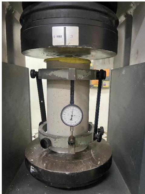
Gambar L-9. 25 Pengujian Kuat Tekan dan Modulus Elastisitas
