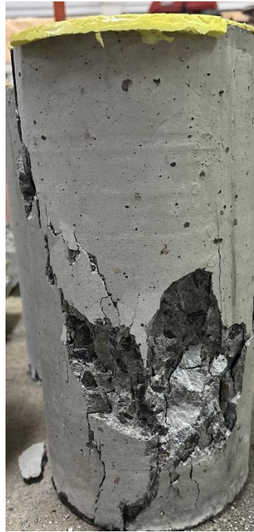
Gambar L-9. 29 Benda Uji setelah Pengujian Kuat Tekan Beton dan Modulus Elastisitas Beton variasi BN Sampel 3
