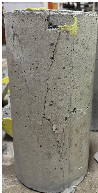
Gambar L-9. 28 Benda Uji setelah Pengujian Kuat Tekan Beton dan Modulus Elastisitas Beton variasi BN Sampel 2
