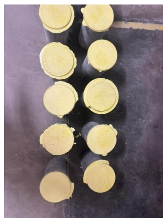
Gambar L-9. 24 Beton Setelah Capping
