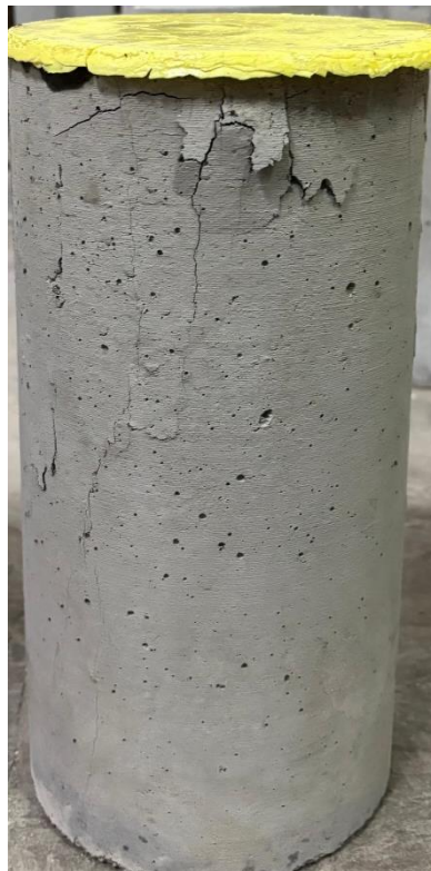
Gambar L-9. 41 Benda Uji setelah Pengujian Kuat Tekan Beton dan Modulus Elastisitas Beton variasi BV-10 Sampel 5
