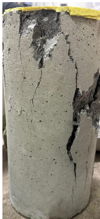
Gambar L-9. 30 Benda Uji setelah Pengujian Kuat Tekan Beton dan Modulus Elastisitas Beton variasi BN Sampel 4
