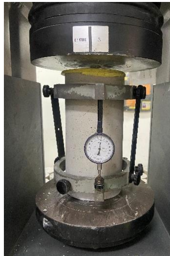
Gambar 5. 17 Contoh Pengujian Modulus Elastisitas Beton (Sumber: Dokumentasi Pribadi)
