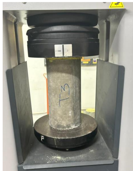
Gambar 5. 8 Contoh Pengujian Kuat Tekan Beton (Sumber: Dokumentasi Pribadi)
