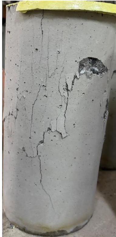
Gambar L-9. 43 Benda Uji setelah Pengujian Kuat Tekan Beton dan Modulus Elastisitas Beton variasi BV-15 Sampel 2
