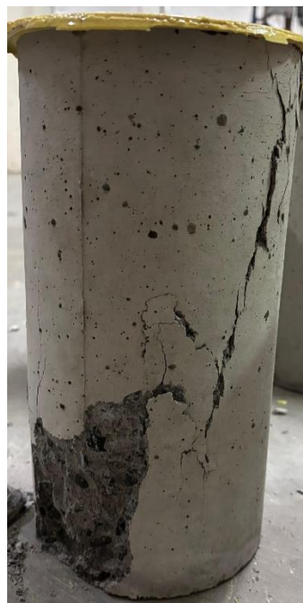
Gambar L-9. 34 Benda Uji setelah Pengujian Kuat Tekan Beton dan Modulus Elastisitas Beton variasi BV-05 Sampel 3
