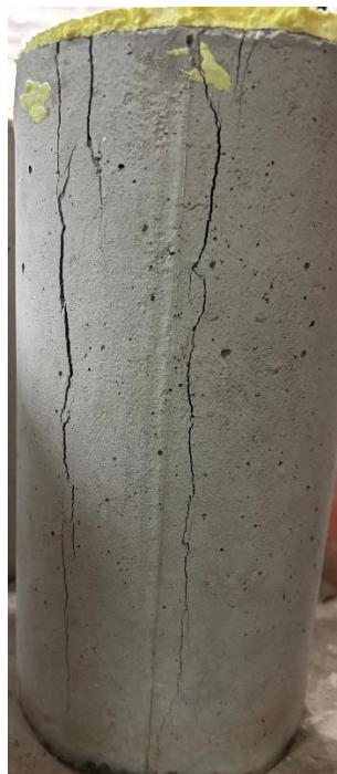
Gambar L-9. 44 Benda Uji setelah Pengujian Kuat Tekan Beton dan Modulus Elastisitas Beton variasi BV-15 Sampel 3
