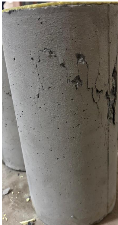
Gambar L-9. 46 Benda Uji setelah Pengujian Kuat Tekan Beton dan Modulus Elastisitas Beton variasi BV-15 Sampel 5
