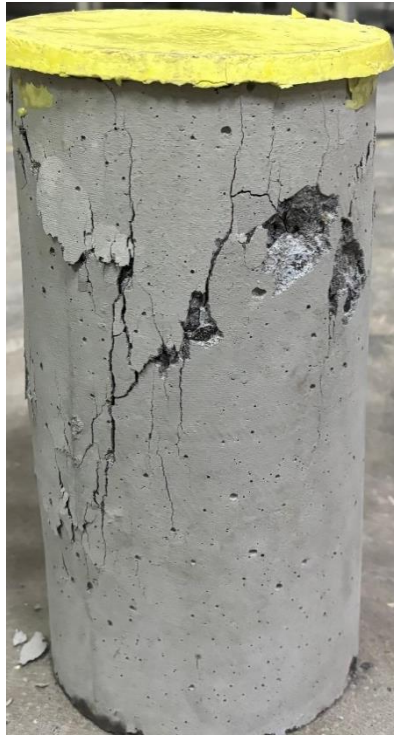
Gambar L-9. 49 Benda Uji setelah Pengujian Kuat Tekan Beton dan Modulus Elastisitas Beton variasi BV-20 Sampel 3
