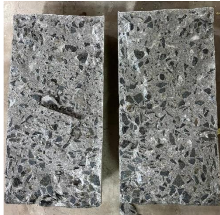
Gambar 5. 27 Contoh Hasil Uji Tarik Belah Beton (Sumber: Dokumentasi Pribadi)
