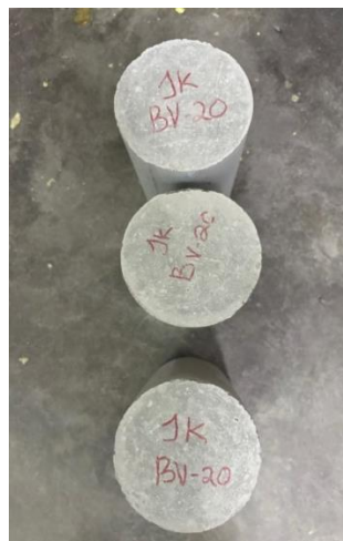
Gambar L-9. 23 Beton Siap Uji
