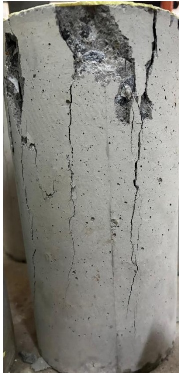
Gambar L-9. 51 Benda Uji setelah Pengujian Kuat Tekan Beton dan Modulus Elastisitas Beton variasi BV-20 Sampel 5
