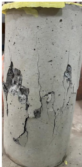
Gambar L-9. 42 Benda Uji setelah Pengujian Kuat Tekan Beton dan Modulus Elastisitas Beton variasi BV-15 Sampel 1
