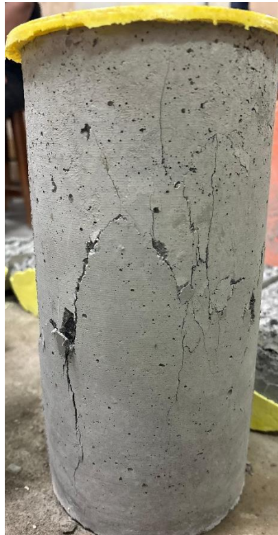
Gambar L-9. 31 Benda Uji setelah Pengujian Kuat Tekan Beton dan Modulus Elastisitas Beton variasi BN Sampel 5
