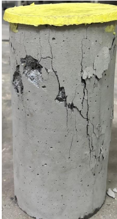
Gambar L-9. 37 Benda Uji setelah Pengujian Kuat Tekan Beton dan Modulus Elastisitas Beton variasi BV-10 Sampel 1
