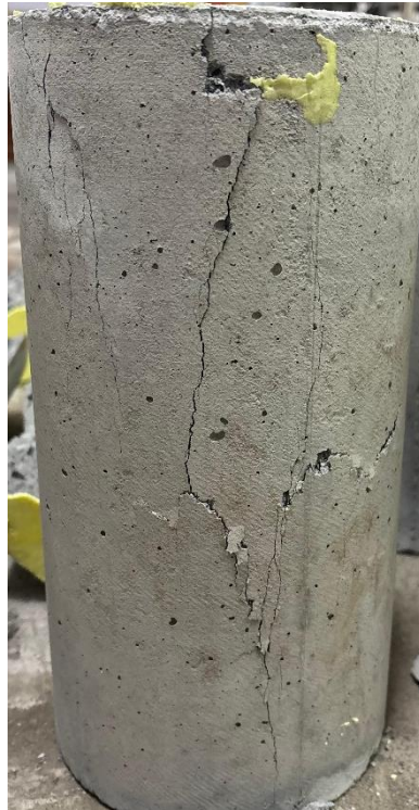
Gambar L-9. 47 Benda Uji setelah Pengujian Kuat Tekan Beton dan Modulus Elastisitas Beton variasi BV-20 Sampel 1
