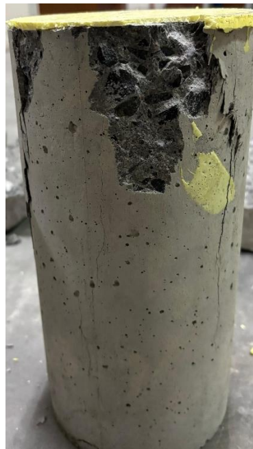
Gambar L-9. 36 Benda Uji setelah Pengujian Kuat Tekan Beton dan Modulus Elastisitas Beton variasi BV-05 Sampel 5
