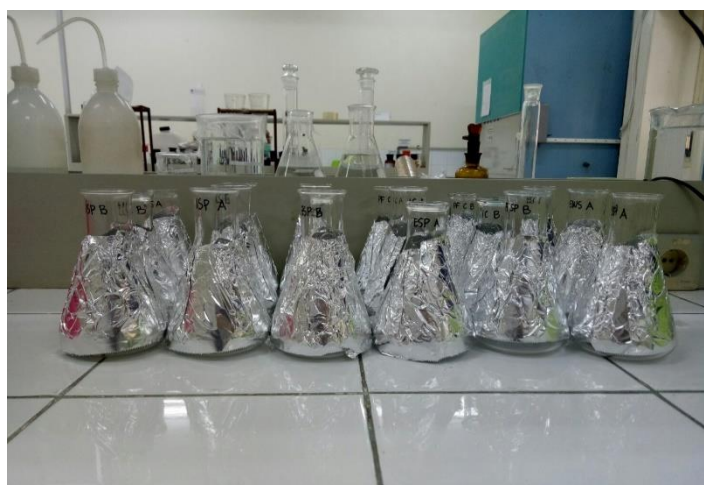
Gambar 4.19 Preparasi sampel untuk pengujian kalium permanganat (Sumber : Dokumentasi, 2018)
