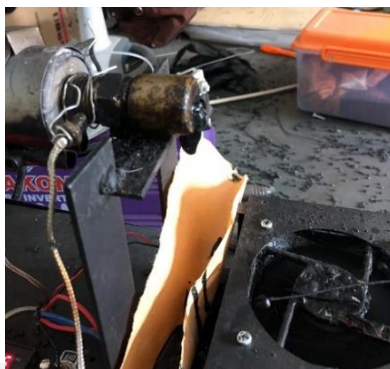
Gambar 4.7 Filamen yang keluar dari nozzle terlalu cair
