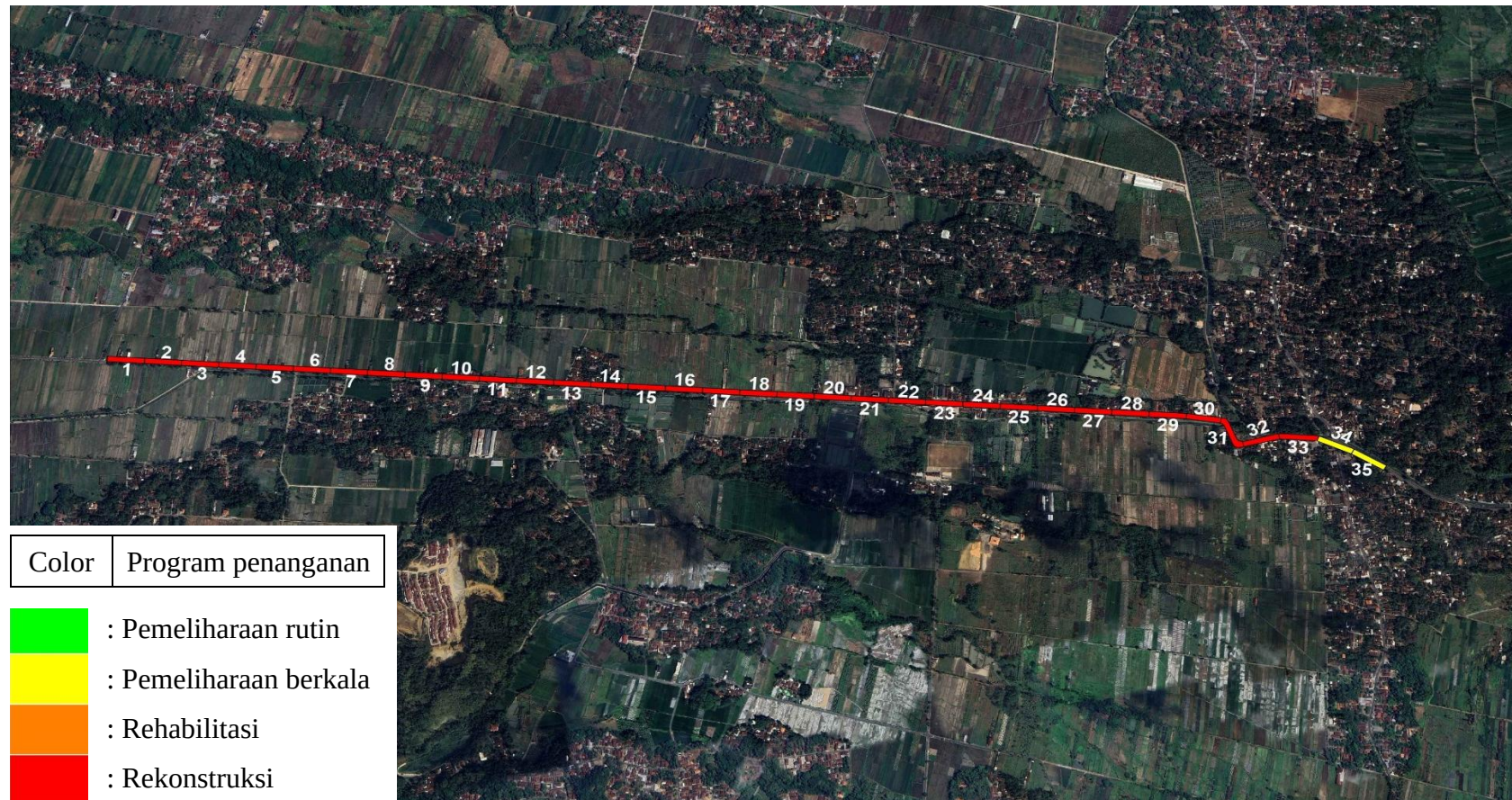
Gambar 5. 5 Penanganan Perbaikan Permukaan ruas Jalan Klangon-Tempel segmen 1 sampai 35
