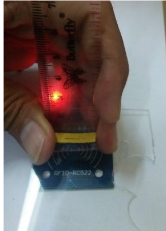
Gambar 4-6 Pembacaan Cip dengan jarak baca 10 mm
