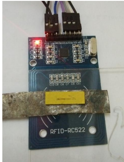
Gambar 4-1 Pembacaan Cip dengan penghalang ASTM A36-SNI
