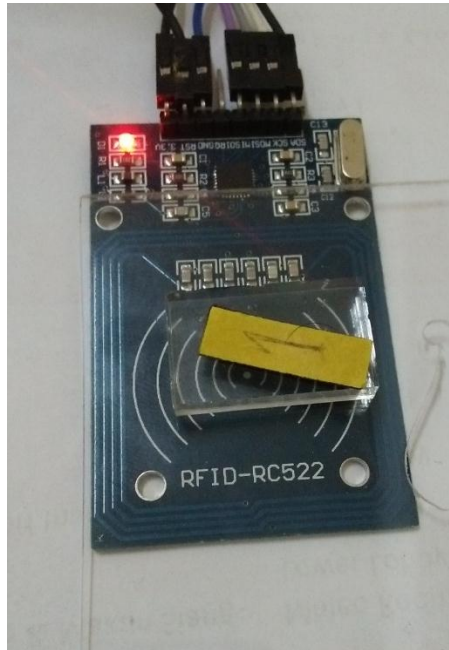
Gambar 4-5 Pembacaan Cip dengan penghalang resin
