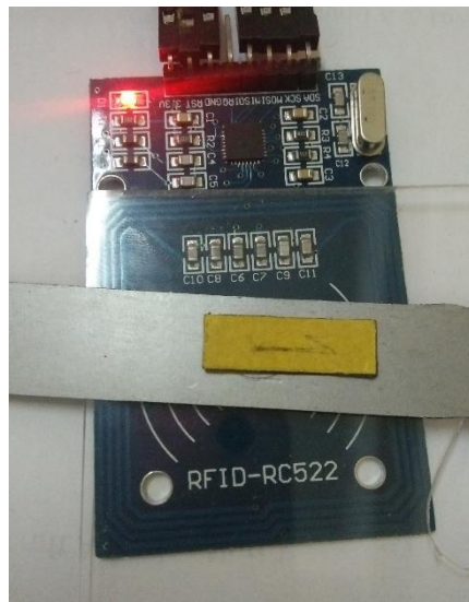
Gambar 4-2 Pembacaan Cip dengan penghalang stanless steel
