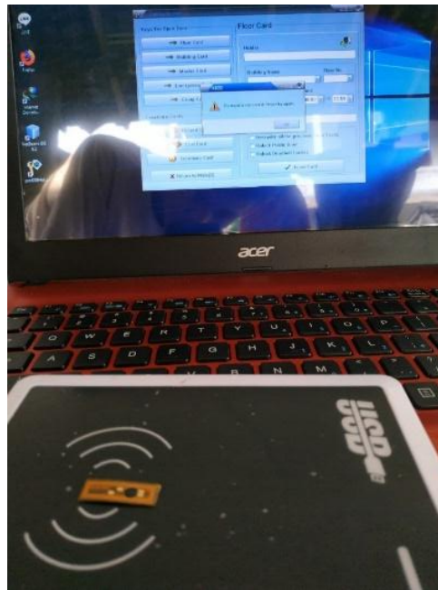
Gambar 3-4 mencoba akses cip dengan RFID yang ada pada handle pintu
