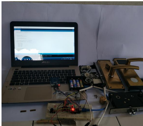
Gambar 3-12 mengontrol motor DC, LED, Buzer dengan cip.
