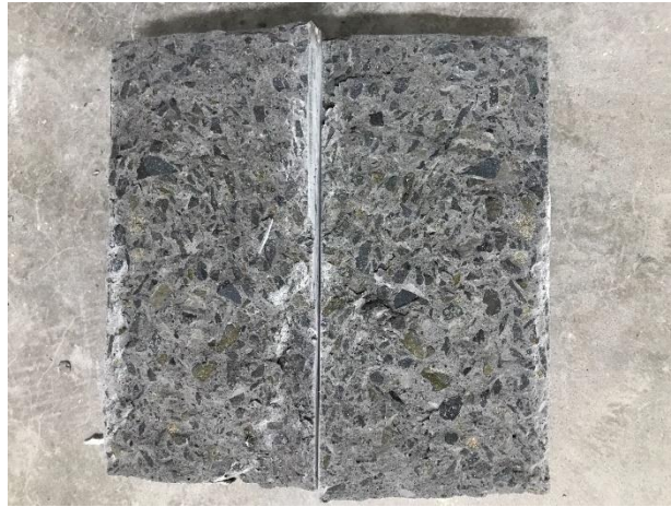
Gambar Lampiran 8.15 Hasil Pengujian Kuat Tarik Beton
