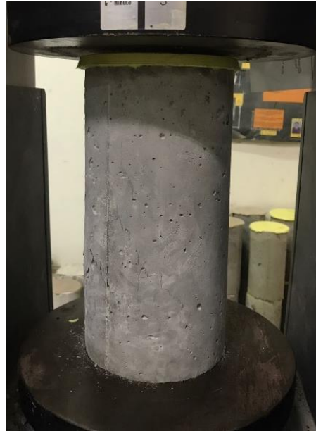
Gambar 5.11 Pengujian Kuat Desak Beton
