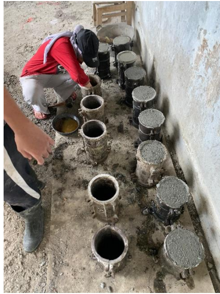
Gambar Lampiran 8.9 Proses Cetak Beton
