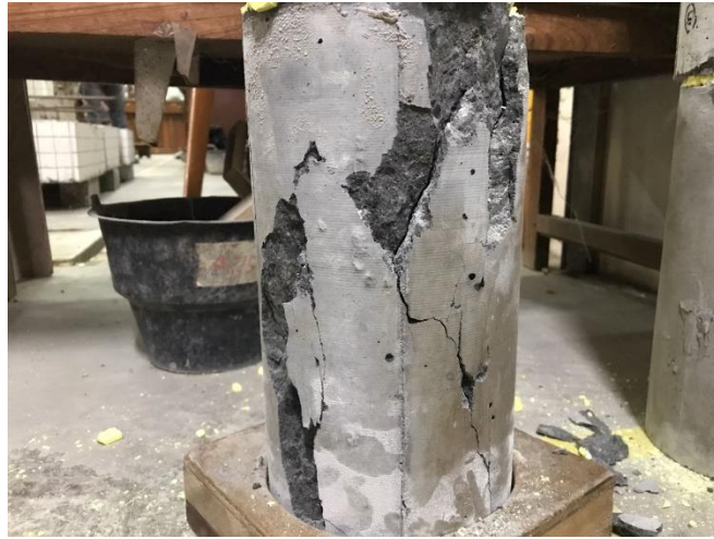
Gambar Lampiran 8.13 Hasil Pengujian Kuat Tekan Beton
