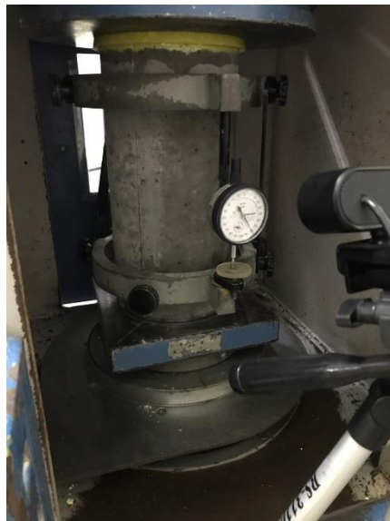
Gambar Lampiran 8.12 Proses Pengujian Kuat Tekan Beton
