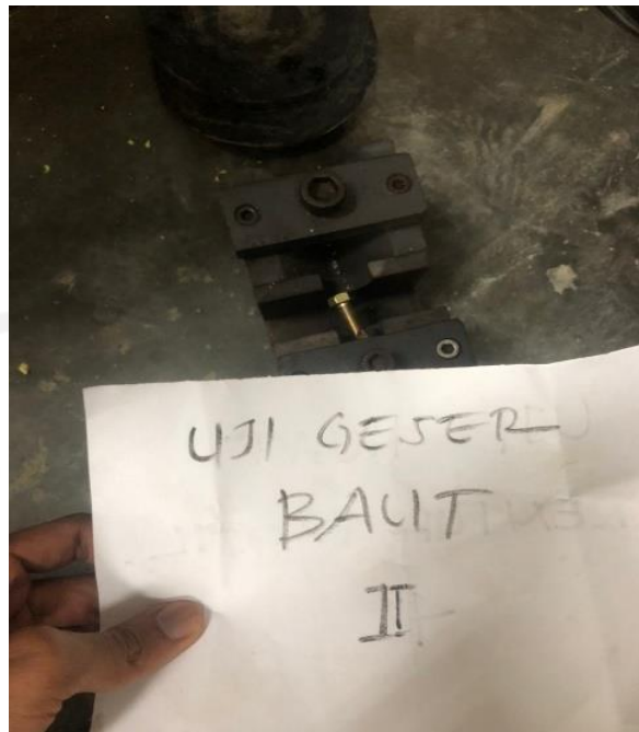
Gambar 5.7 Pengujian Kuat Geser Baut Sampel 2
