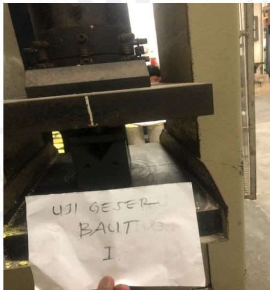
Gambar 5.6 Pengujian Kuat Geser Baut Sampel 1
