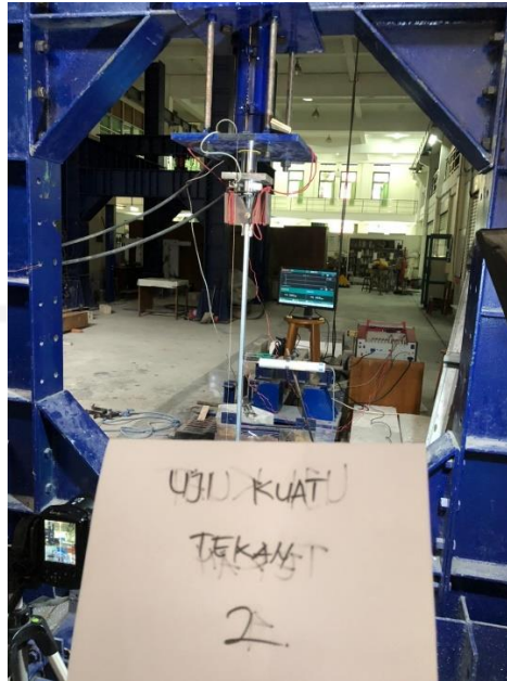
Gambar 5.9 Pengujian Kuat Tekan Profil Variasi 1 Baut Sampel 2
