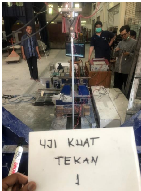
Gambar 5.8 Pengujian Kuat Tekan Profil Variasi 1 Baut Sampel 1
