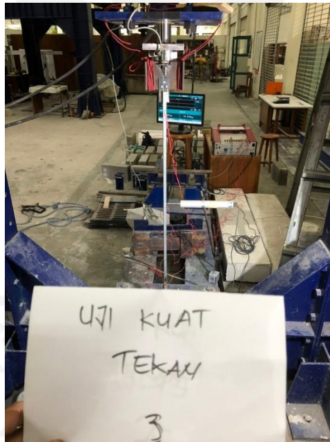
Gambar 5.10 Pengujian Kuat Tekan Profil Variasi 3 Baut Sampel 1
