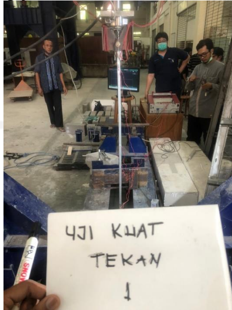
Lampiran 3. Set Up Pengujian Kuat Tekan Profil Variasi 1 Baut
