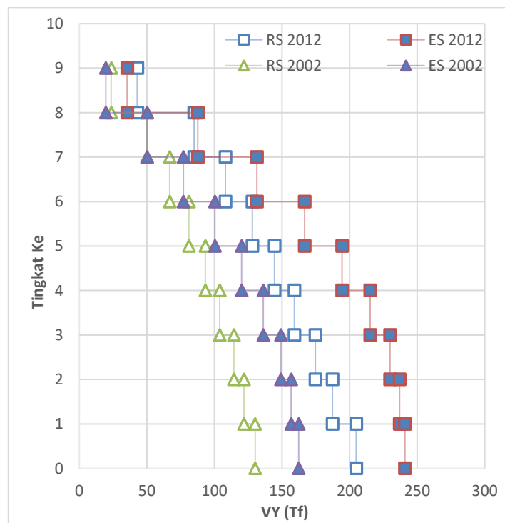
Gambar 5.30 Perbandingan Hasil Analisis Gaya Geser Tingkat Arah y
