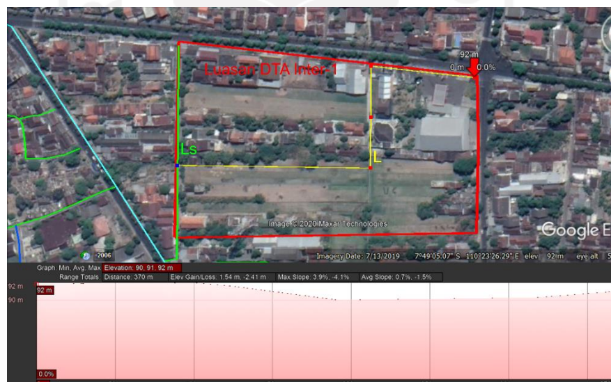
Gambar 5.7 Pengukuran Panjang Lintasan Aliran Di Atas Permukaan Lahan (L) Menggunakan Aplikasi Google Earth pada Saluran Inter 1
