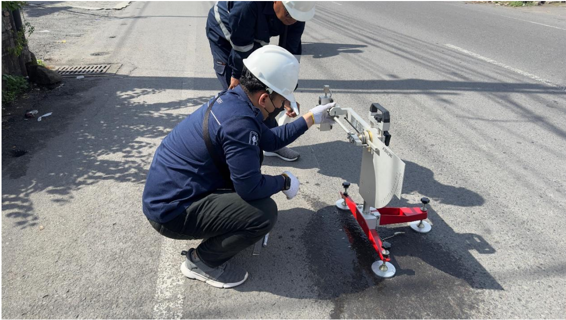
Gambar 19 Pengujian BPT STA 8+700 Kondisi Basah
