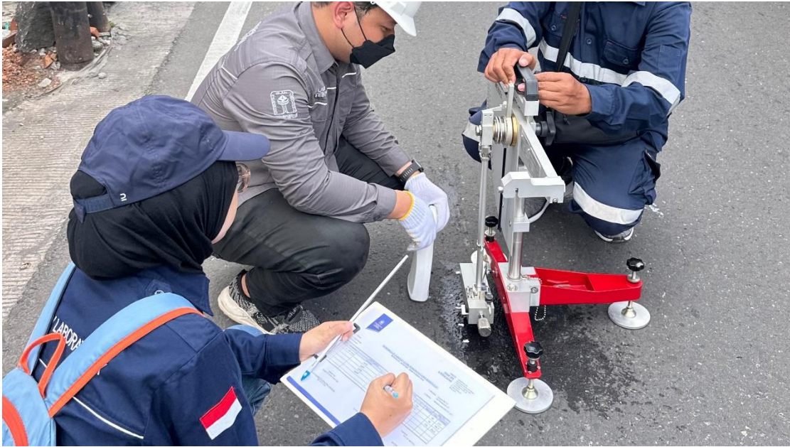
Gambar 11 Pengujian BPT STA 8+000 Kondisi Basah
