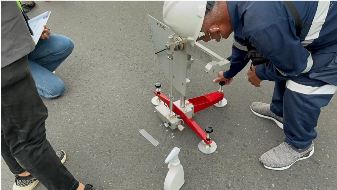
Gambar 5 Pengujian BPT STA 8+800 Kondisi Kering
