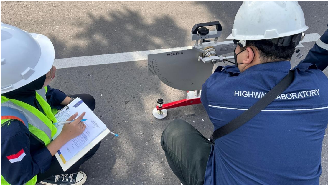
Gambar 3 Pengujian BPT STA 8+400 Kondisi Kering
