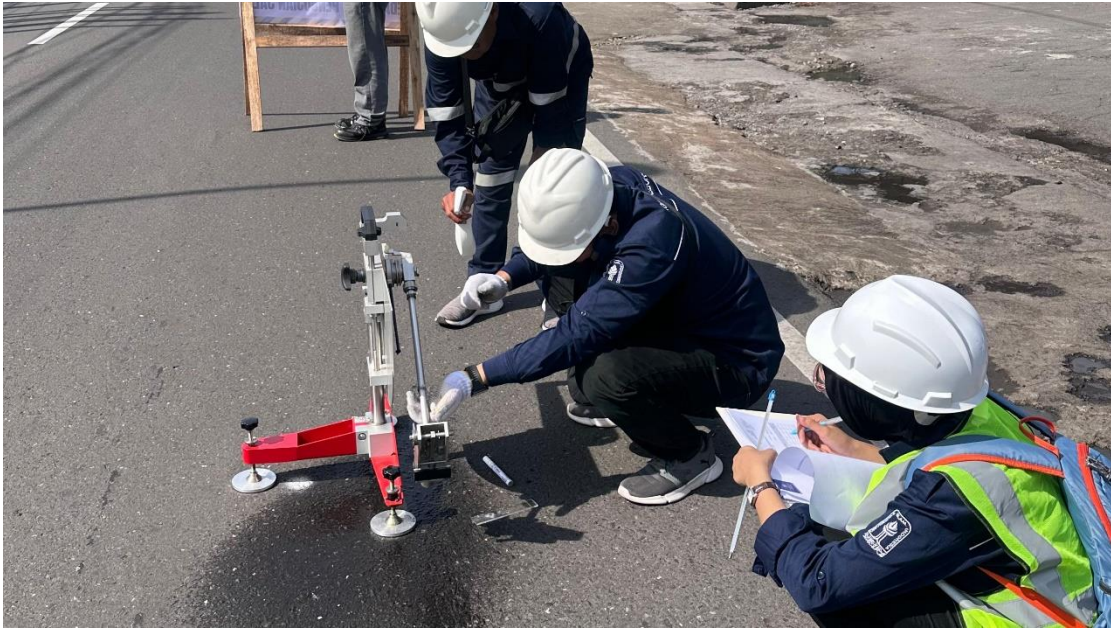
Gambar 13 Pengujian BPT STA 8+400 Kondisi Basah
