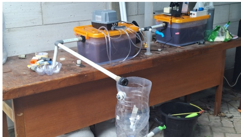
Gambar Lampiran 1. 2 Rancangan Reaktor Anaerob-Aerob dan Clarifier
