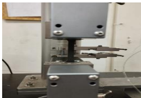
Gambar 3.14. Spesimen yang di jepit pada grip mesin uji tarik.
