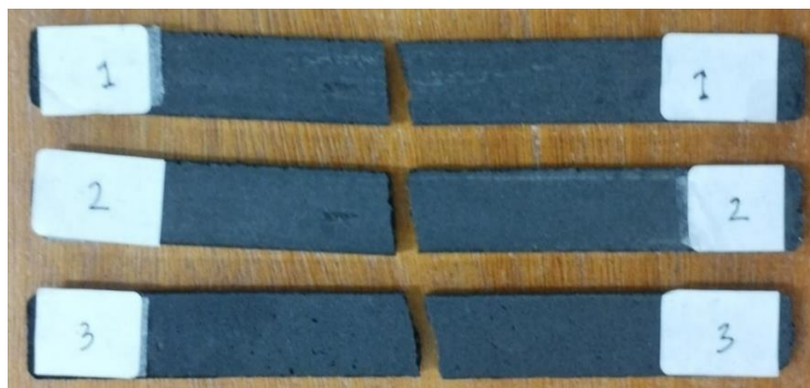
Spesimen uji lentur 15 MPa setelah di uji.
