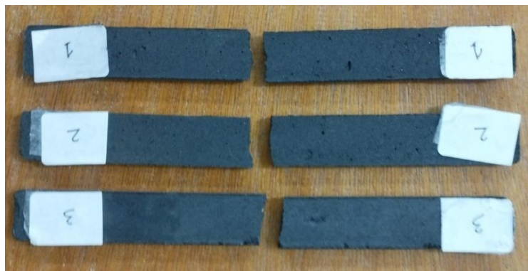
Spesimen uji lentur 5 MPa setelah di uji.
