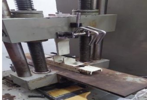
Gambar 3.17. Posisi spesimen dengan metode three poin bending .
