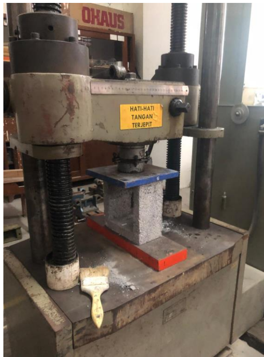
Gambar 4.6 Pengujian Kuat Tekan Roster Beton Motif Lubang 1
