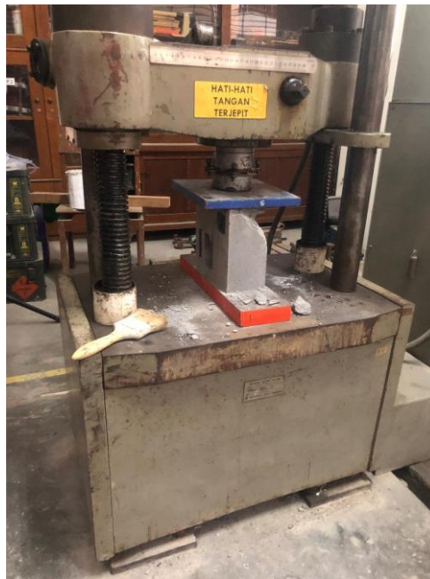
Gambar 4. 8 Pengujian Kuat Tekan Roster Beton Motif Lubang 4
