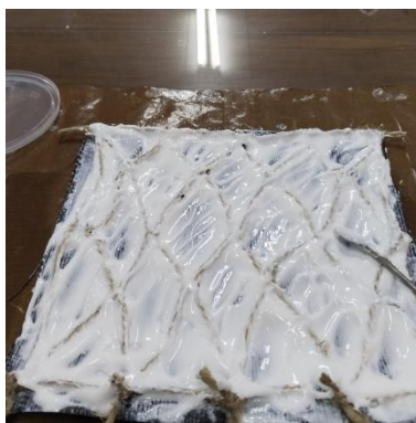
Gambar 3. 85 Matriks di atas Geomats
