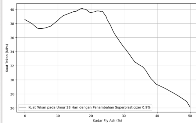
Gambar 5.42 Grafik Kuat Tekan Beton Berdasarkan Proporsi Fly ash dengan Penambahan Kadar Superplasticizer 0,9%
