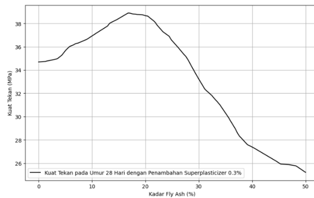
Gambar 5.36 Grafik Kuat Tekan Beton Berdasarkan Proporsi Fly ash dengan Penambahan Kadar Superplasticizer 0,3%
