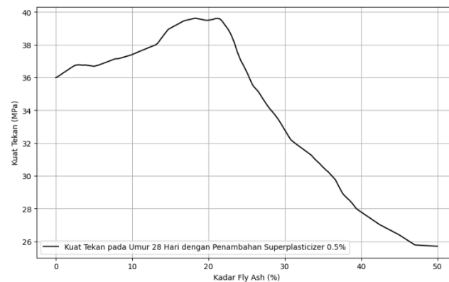
Gambar 5.38 Grafik Kuat Tekan Beton Berdasarkan Proporsi Fly ash dengan Penambahan Kadar Superplasticizer 0,5%
