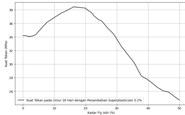
Gambar 5.35 Grafik Kuat Tekan Beton Berdasarkan Proporsi Fly ash dengan Penambahan Kadar Superplasticizer 0,2%
