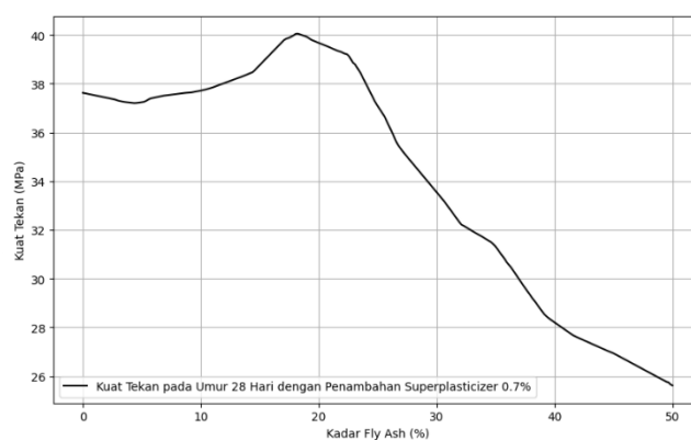
Gambar 5.40 Grafik Kuat Tekan Beton Berdasarkan Proporsi Fly ash dengan Penambahan Kadar Superplasticizer 0,7%
