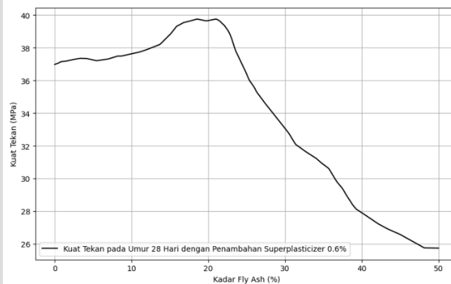
Gambar 5.39 Grafik Kuat Tekan Beton Berdasarkan Proporsi Fly ash dengan Penambahan Kadar Superplasticizer 0,6%
