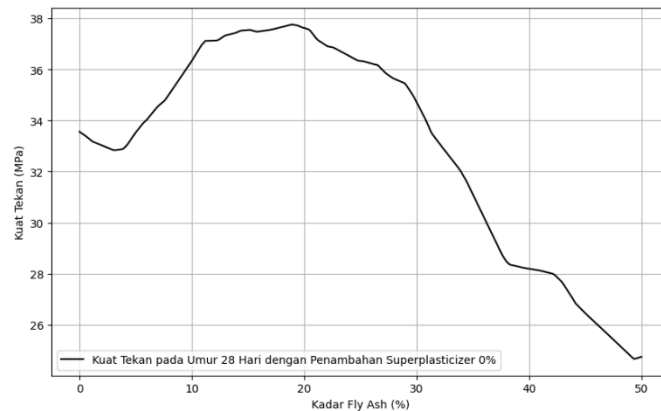
Gambar 5.33 Grafik Kuat Tekan Beton Berdasarkan Proporsi Fly ash dengan Penambahan Kadar Superplasticizer 0%
