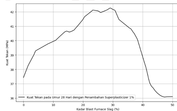
Gambar 5.55 Grafik Kuat Tekan Beton Berdasarkan Proporsi Blast Furnace Slag dengan Penambahan Kadar Superplasticizer 1%
