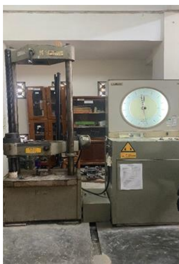
Gambar 4. Uji Kuat Tekan Mortar Geopolimer
