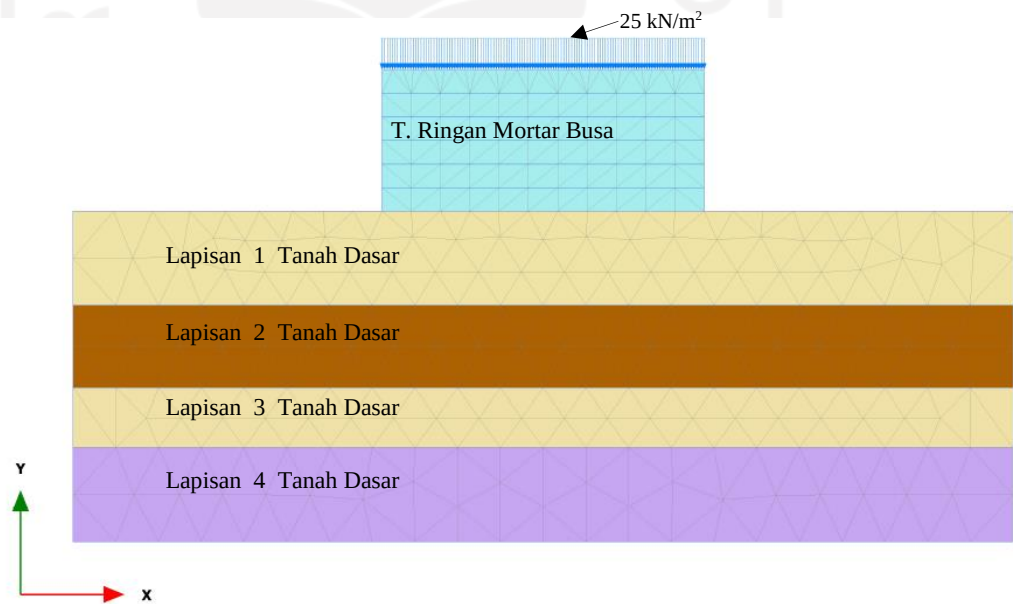
Gambar 5.8 Jaringan Elemen Timbunan Ringan Mortar Busa ditinjau Konstruksi Bertahap
