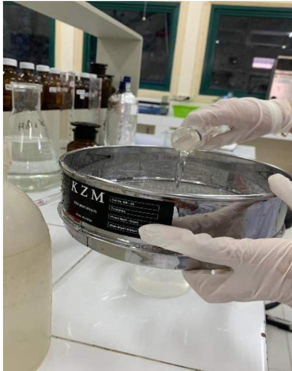
Gambar 3. 6 Proses Penyaringan Basah
