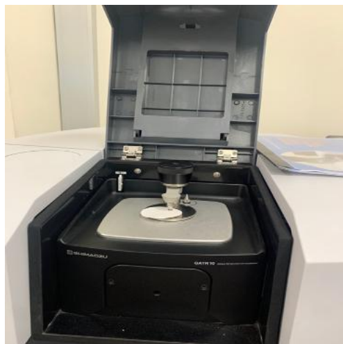
Gambar 3. 11 Identifikasi Jenis Polimer Mikroplastik Menggunakan FTIR
