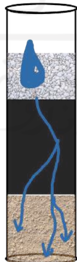
GAMBAR 4.32 Skema Isi Pipa Sumber : Penulis, 2022
