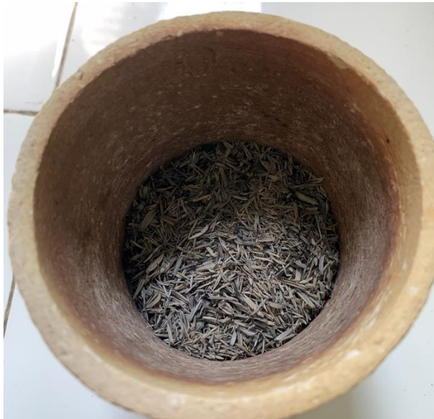
Hasil Furnace Sekam Padi dengan Suhu 600°C
