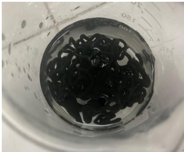
Pembuatan Alginat Worm Fiber Adosrben Sekam Padi
