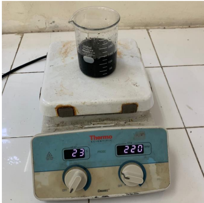
Proses Aktivasi Adsorben Sekam Padi selama 48 Jam
