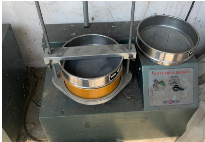
Proses Pengayakan dengan Ukuran 100 mesh
