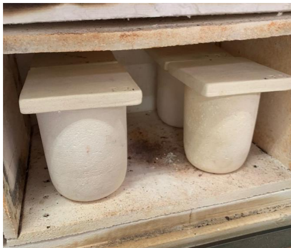
Sekam Padi Dimasukkan ke dalam Furnace
