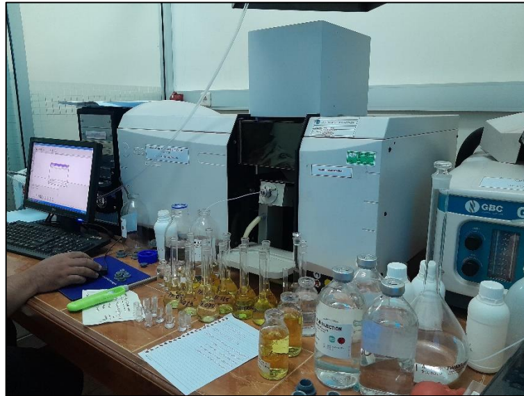
Gambar 3.12 Analisis Kandungan Logam Berat dengan SSA
