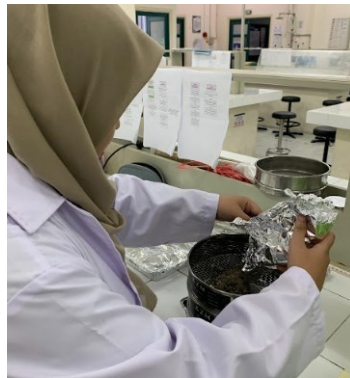
Lampiran 2.3 Proses Pengayakan Sedimen Kering
