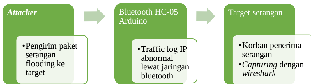
Gambar 3.6 Tahap simulasi serangan flooding pada perangkat IoT
