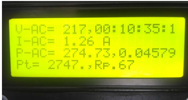
Gambar 4.3 Monitoring Daya, KWh, dan Estimasi Biaya
