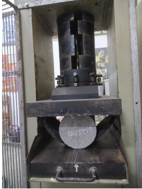
Gambar L-5.2 Proses Pengujian Kuat Tarik Belah Beton
