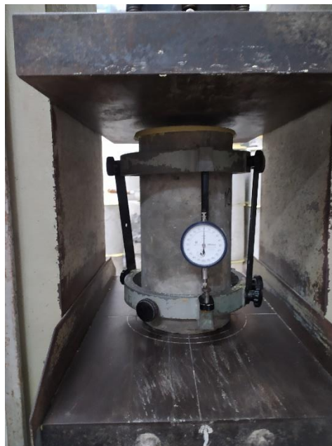
Gambar L-5.1 Proses Pengujian Kuat Tekan dan Modulus Elastisitas Beton
