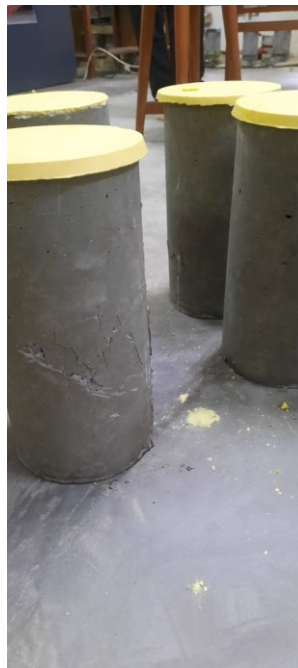
Gambar L-4. 4 Benda Uji Setelah Pengujian Kuat Tekan Beton
