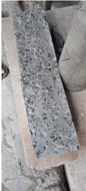
Gambar L-4. 5 Benda Uji Setelah Pengujian Kuat Tarik Belah Beton
