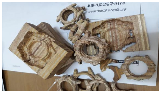
Gambar 4-4 Hasil Pemesinan Case Yang Gagal
