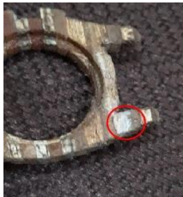
Gambar 4-12 Bekas Pengeleman Menggunakan Lem Kayu/Lem Putih
