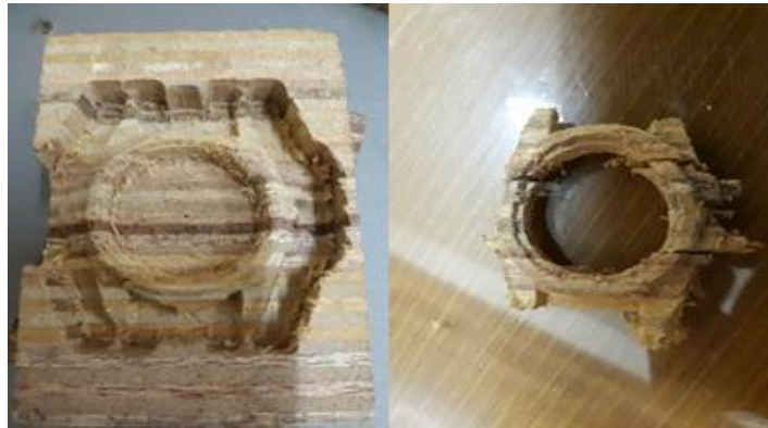
Gambar 4-3 Hasil Pemesinan Pertama Kali Case Jam Pria dan Wanita
