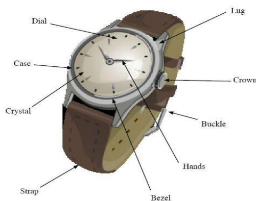
Gambar 2-1 Bagian-bagian Pada Jam Tangan
