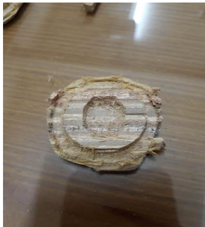
Gambar 4-5 Hasil Pemesinan Back Case
