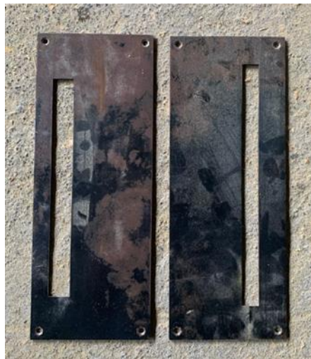
Gambar 4 - 45 Hasil Pembuatan Insert Plate
