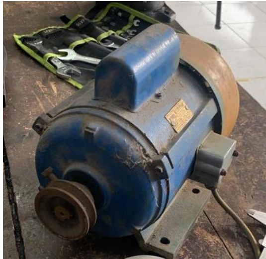
Gambar 4 - 4 Motor Induksi yang Digunakan
