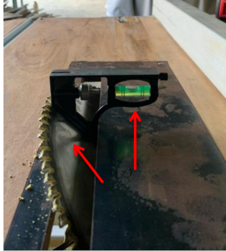
Gambar 4 - 53 Posisi Mata Pisau pada Sudut 45^\circ
