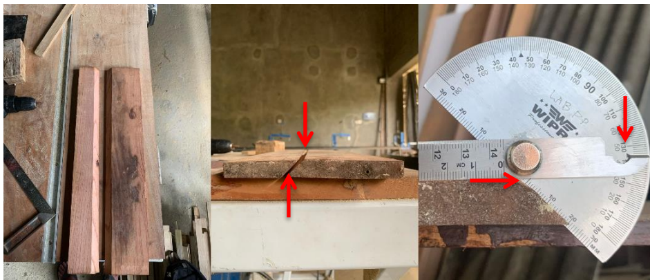
Gambar 4 - 56 Hasil Pembelahan Sudut 45^\circ Papan Suren
