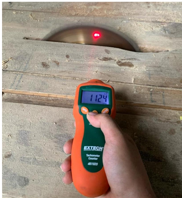
Gambar 4 - 31 Kecepatan Mata Pisau Tanpa Beban pada Mesin Table Saw Statis UMKM Rosse Bambu
