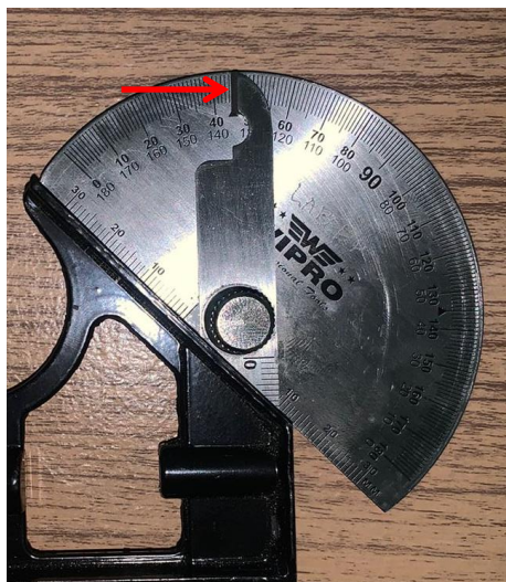
Gambar 4 - 54 Pengukuran Sudut pada Waterpass
