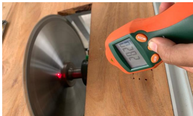
Gambar 4 - 49 Kecepatan Mata Pisau Tanpa Beban
