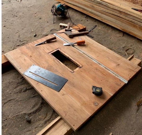
Gambar 4 - 46 Hasil Pembuatan Dudukan Insert Plate
