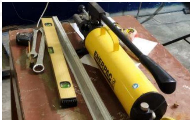
Gambar 4.27 Hydraulic Jack Uji Tekan Rangka Atap
