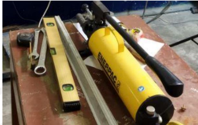
Gambar 4.19 Hydraulic Jack Uji Tekan Profil
