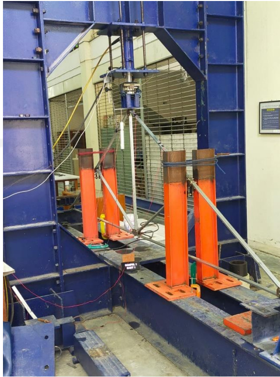
Gambar 4.26 Loading Frame Uji Tekan Rangka Atap
