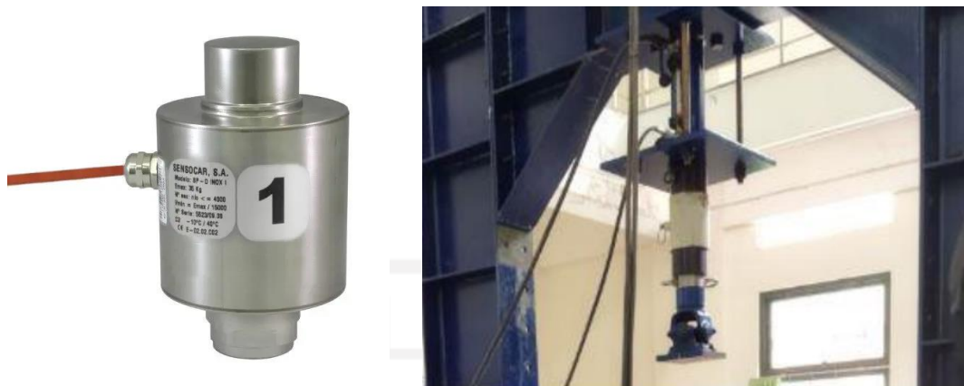
Gambar 4.21 Compression Load Cell Uji Tekan Profil
