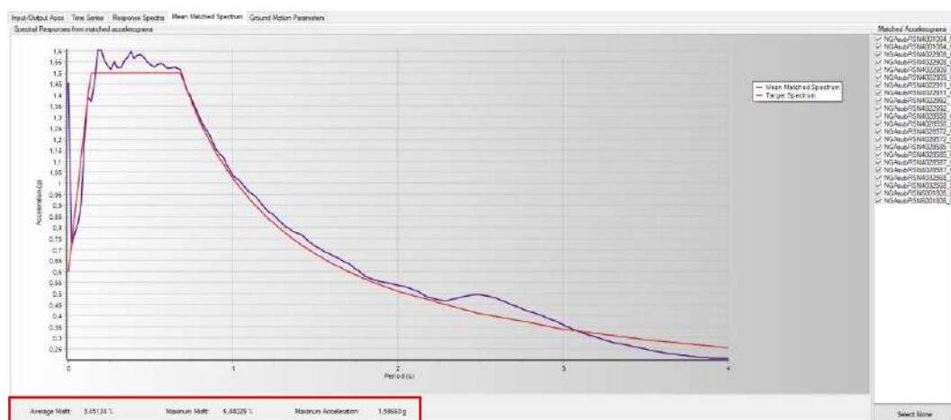
Gambar 5.68 Perbandingan Antara Spektra Target Dengan Spektra Gempa Tercocokan Rata-Rata ( Mean Matched Spectra ) Sumber Gempa Megathrust
