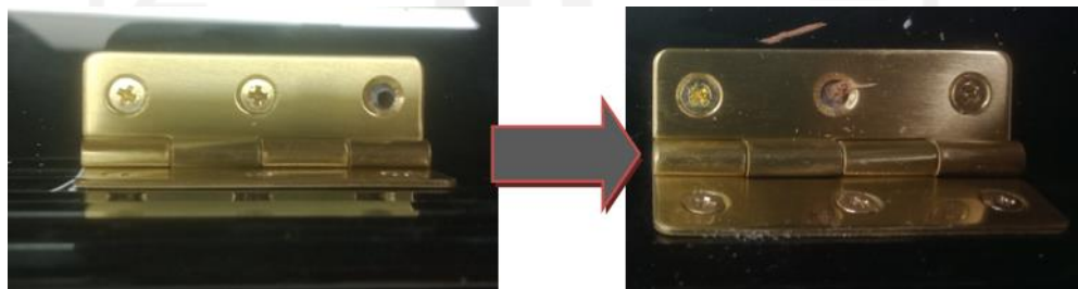
Gambar 3-5 Penambalan lubang yang tidak presisi dengan lubang engsel
