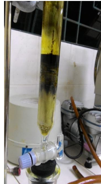
Gambar 10. Kromatografi vakum cair pada ekstrak n-heksana
