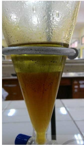
Gambar 9. Ekstraksi cair-cair menggunakan corong pisah dengan pelarut n-heksana
