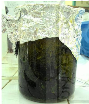
Gambar 7. Maserasi daun sukun menggunakan pelarut etanol 96 %
