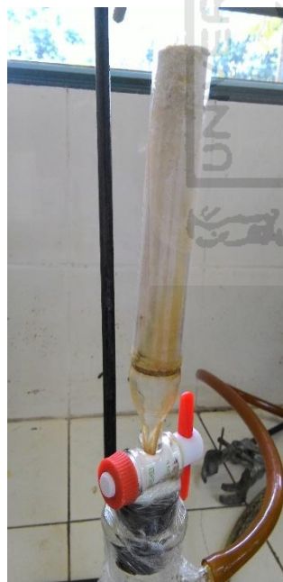
Gambar 11. Kromatografi vakum cair pada ekstrak pekat etanol
