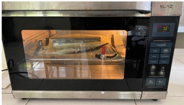
Gambar 3. 26 Proses Curing Spesimen
