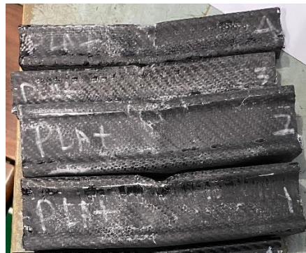
Gambar 4. 2 Hasil Pengujian PLA+ Karbon Twill
