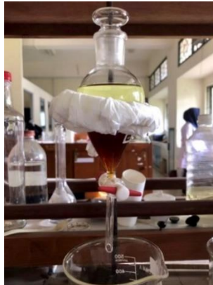
Gambar 13. Pemisahan Trigliserida dari Metanol
