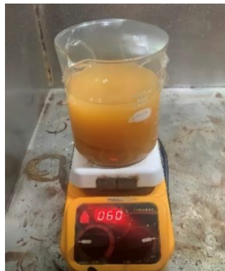
Gambar 12. Proses Pencucian Minyak Jelantah dengan Metanol
