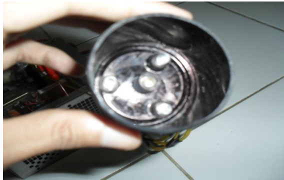
Gambar 3.4 Tabung hitam serta penempatan LED dan Foto Transistor
