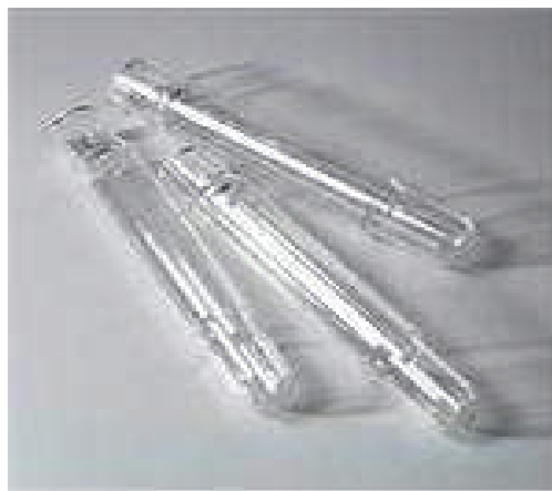
Gambar 5. Tabung Kjeltec FOSS
