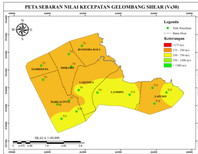
Gambar 2. 10 Peta Sebaran Nilai Kecepatan Gelombang Shear ( V_{s30} )
