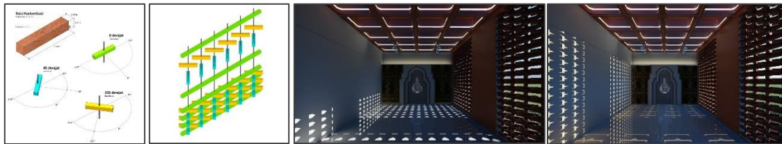
Gambar 5 Pola susunan bata A2 (1&2), visual pembayangan pukul 12:00 (3) dan pukul 16:00 (4) Sumber : Data peneliti 2023
