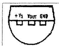
Gambar 2.5. Konfigurasi pin-pin sensor suhu IC LM35
