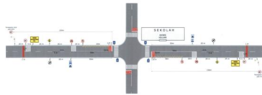
Gambar 6. Desain teknis ZoSS pada persimpangan jalan (Sumber: Perdirjen Hubdat, 2018)
