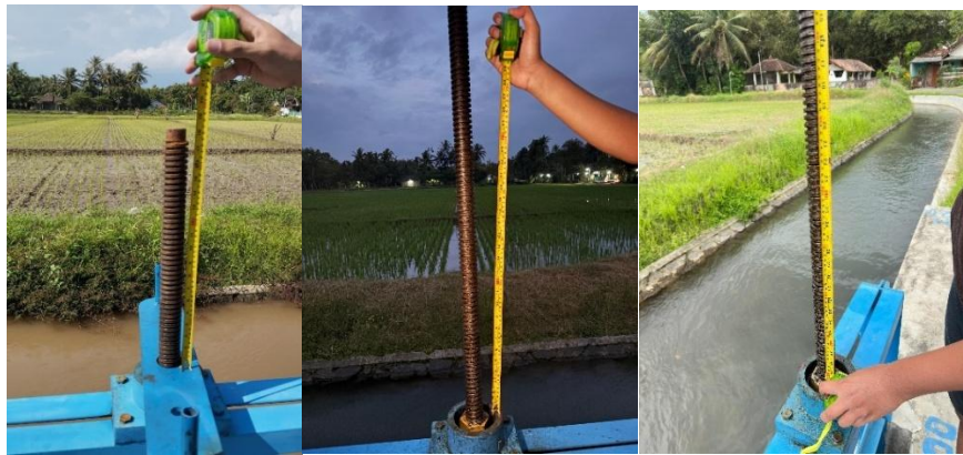
Gambar 5.5 Ukuran Tinggi Bukaan Pintu 0,5 meter, 0,75 meter, 1 meter
