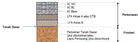
Gambar 3. 1 Struktur Perkerasan Lentur Pada Tanah Asli
