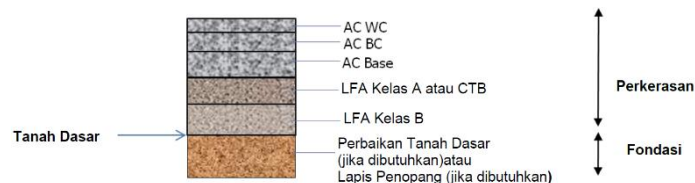
Gambar 3. 3 Struktur Perkerasan Lentur Pada Galian
