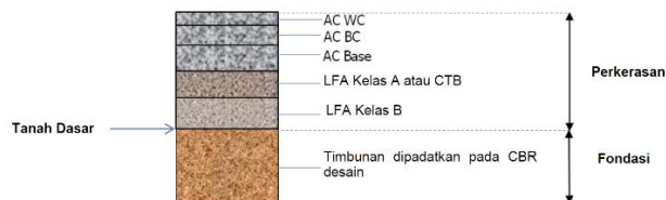
Gambar 3. 2 Struktur Perkerasan Lentur Pada Timbunan
