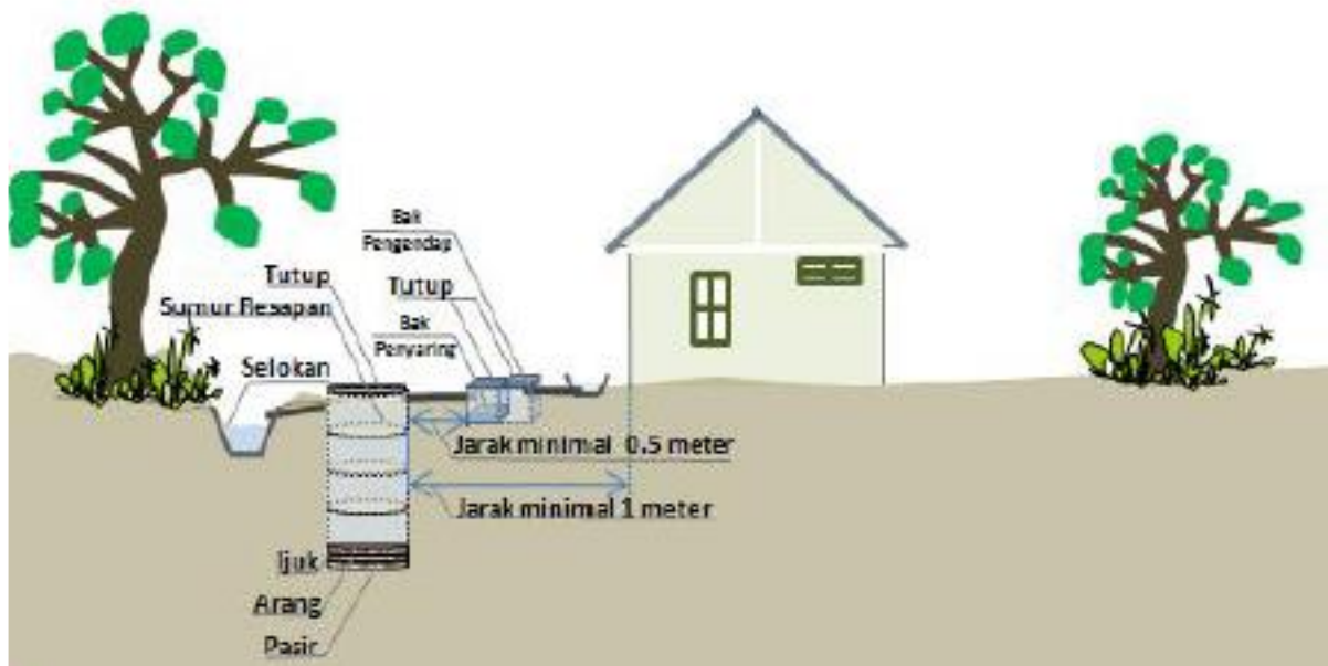
Gambar 2.4 Contoh Sumur Resapan Dangkal berbentuk bulat dengan menggunakan saluran terbuka.
