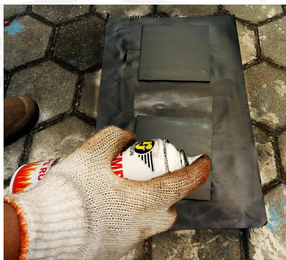
Gambar 4- 24 Proses pengecatan cat tahan panas pada pemanas mesin vulkanisasi.
