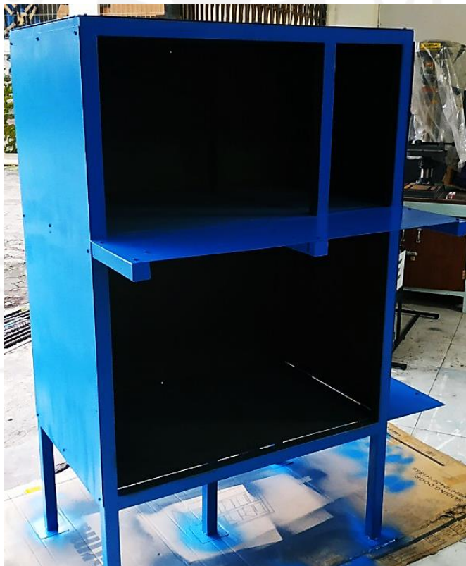
Gambar 4- 19 Hasil pengecatan utama rangka mesin vulkanisasi.
