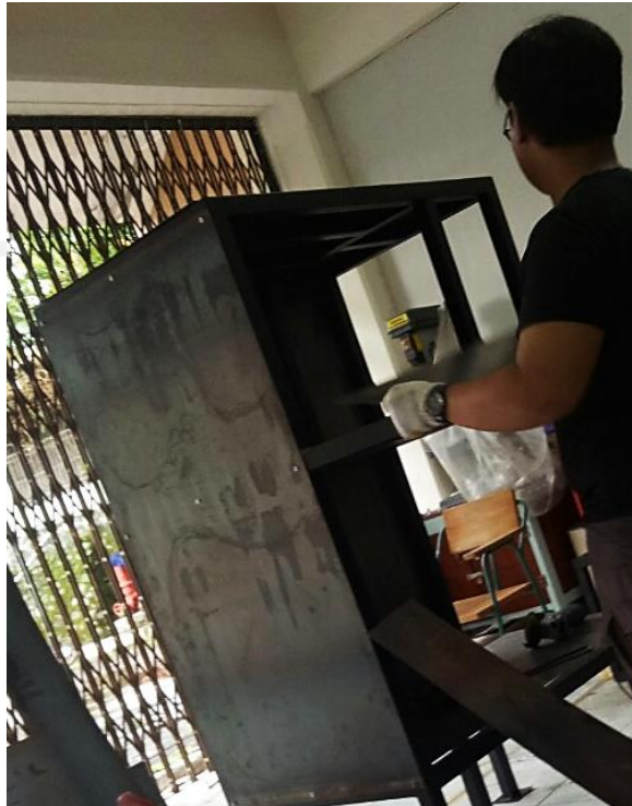
Gambar 4- 15 Peletakan cover pada rangka mesin vulkanisasi.
