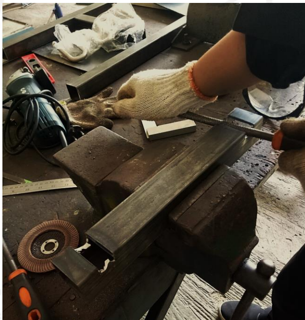
Gambar 4- 20 Hasil pembuatan rangka heater .
