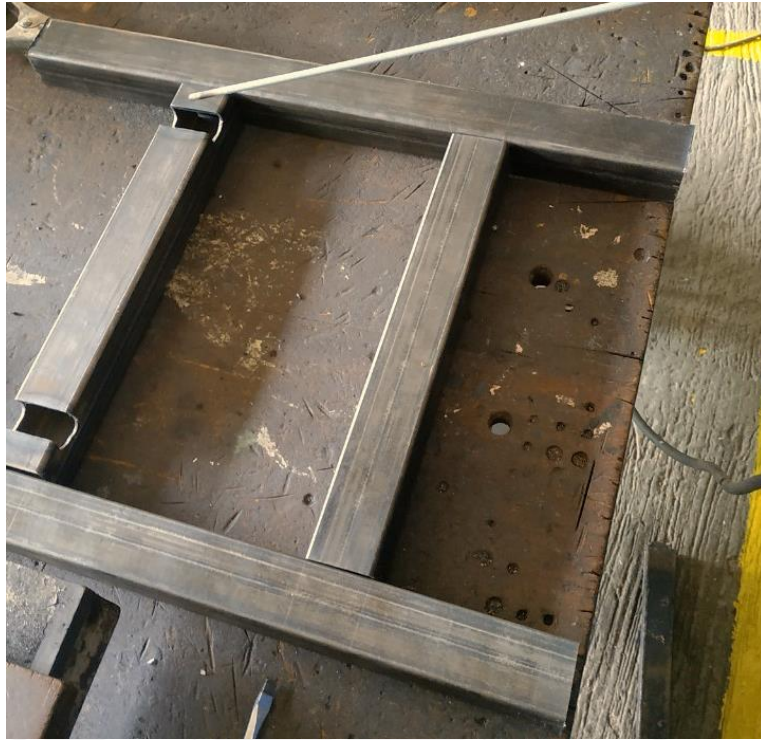
Gambar 4- 21 Proses pengelasan rangka heater .
