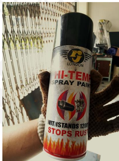
Gambar 4- 23 Cat tahan panas yang digunakan untuk pengecatan pemanas mesin vulkanisasi.
