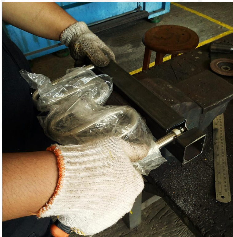
Gambar 4- 22 Proses assembly komponen pemanas.
